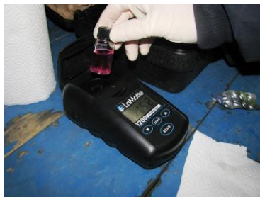
4. Medición de la concentración de cloro libre
